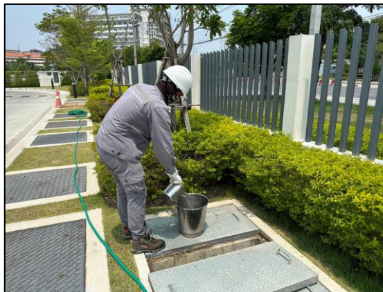
รูปที่ 3.1 การเก็บตัวอย่างคุณภาพน้ำทิ้ง บริเวณ ส่วนพักน้ำเสียของระบบบำบัดน้ำเสีย
